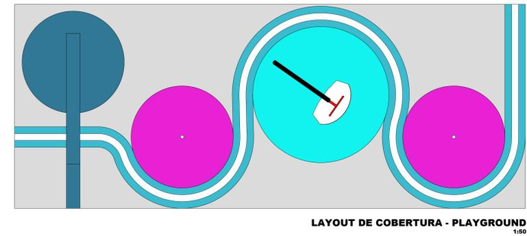
REVESTIMENTO DE PISO: PISO EMBORRACHADO NAS CORES DEFINIDAS EM DETALHAMENTOS.
